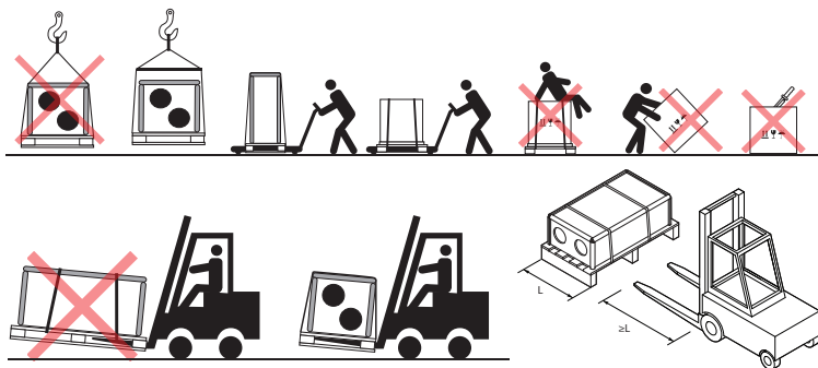
Obr. 4. Príklady prepravy žeriavom, vysokozdvížnym vozíkom a paletovým vozíkom
